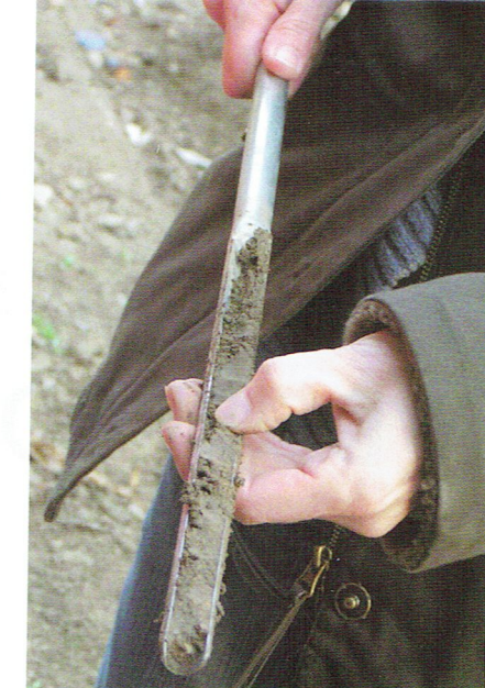
L'ÉCHANTILLON DE TERRE, PRÉLEVÉ AU NIVEAU DES RACINES ACTIVES DE LA PLANTE À L'AIDE D'UNE TARRIÈRE, PERMET D'ÉVALUER MANUELLEMENT L'HUMIDITÉ DU SOL.
