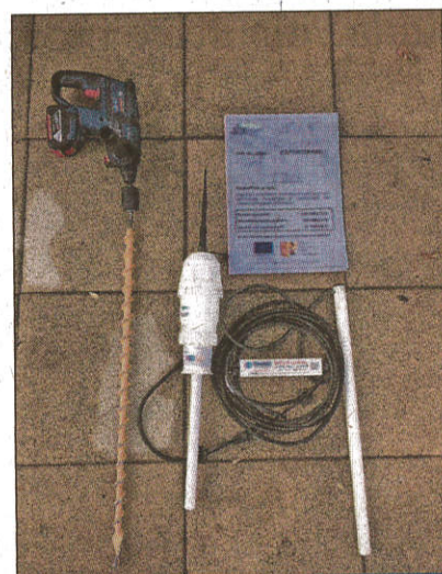
Le boîtier All-in-One GPRS équipé d'une sonde capacitave Sentek Drill and Drop 60 cm avec 6 capteurs humidité et température coulés dans une résine étanche.
