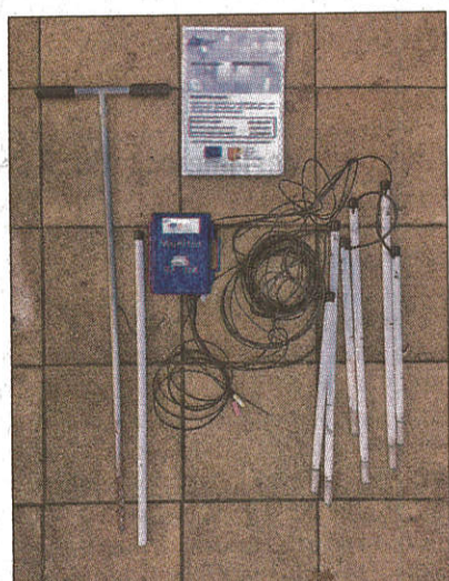
Le boîtier Monitor R2-DX GPRS équipé de 6 sondes tensiométriques Watermark et d'une sonde de température sol et d'une sonde de température air.
