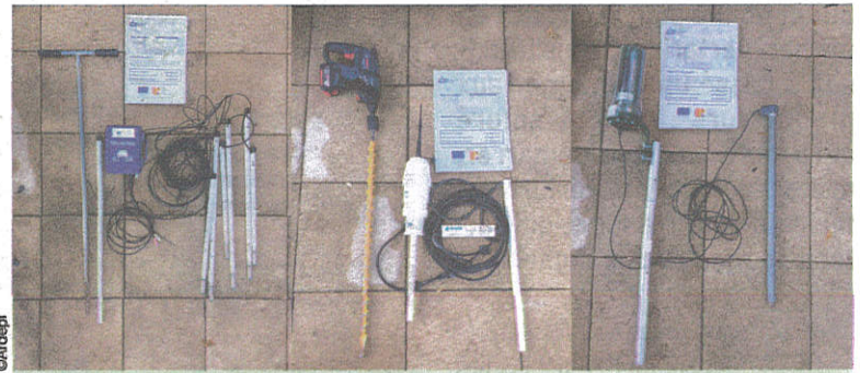
De gauche à droite : le boîtier Monitor R2-DX GPRS équipé de 6 sondes tensiométriques Watermark, d'une sonde de température sol et d'une sonde de température air ; le boîtier All-in-One GPRS équipé d'une sonde capacitativa Sentek Drill and Drop 60 cm, avec 6 capteurs humidité et température coulés dans une résine étanche ; et le boîtier RS130 GPRS équipé d'une sonde capacitativa AquaCheck 60 cm, avec 6 capteurs humidité et température coulé dans une résine étanche.
