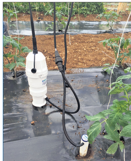
Sonde Sentek Drill and Drop 60 cm sur culture de tomate.
