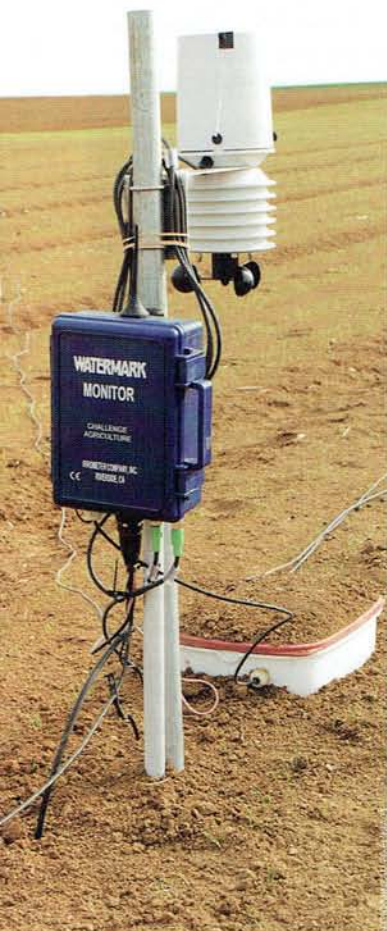
Les producteurs de légumes privilégient les sondes tensiométriques, comme les sondes watermark, pour piloter leur irrigation.
