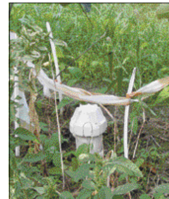
Une sonde Diviner permet de poser dans le sol de son exploitation jusqu'à 99 tubes en tube pvc pour y mesurer l'humidité en continu
