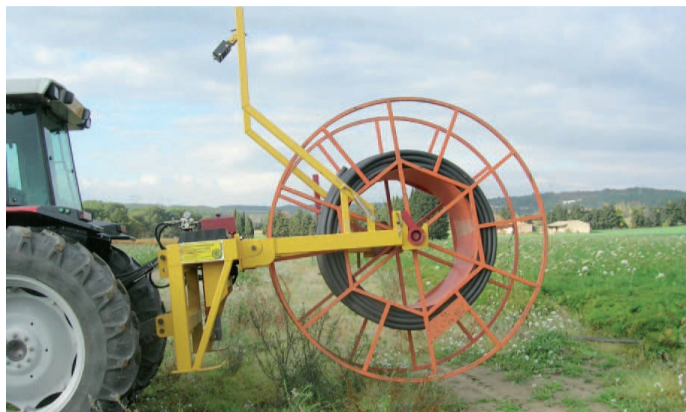
La mini-aspersion est particulièrement adaptée à la couverture intégrale mécanisée : les tubes polyéthylènes sont enroulables sur un touret rond ou ovalisé, dans une optique de meilleure gestion du poste irrigation.
