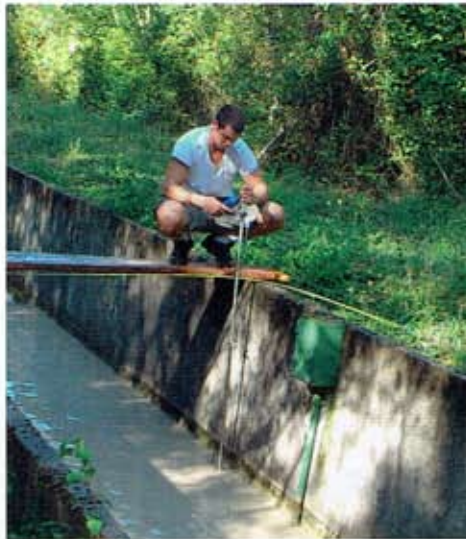
Technicien de l'Ardepi contrôlant une sonde limnimétrique (dans boîtier vert) avec un courantomètre électromagnétique
